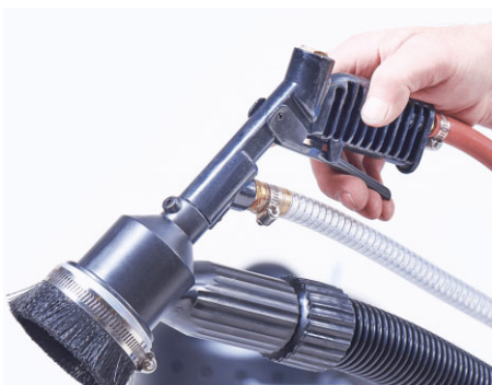
Abb. 7: Schläuche an Behälter und Strahlpistole anschließen
